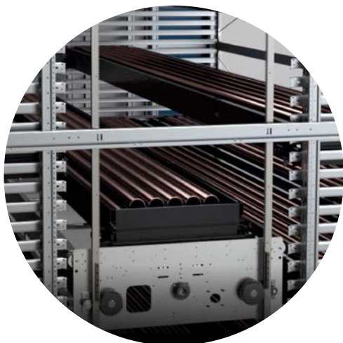
Hissen drivs med kuggjul som löper i homogena kuggstänger. Lastbrickan klarar upp till 750 kg.
